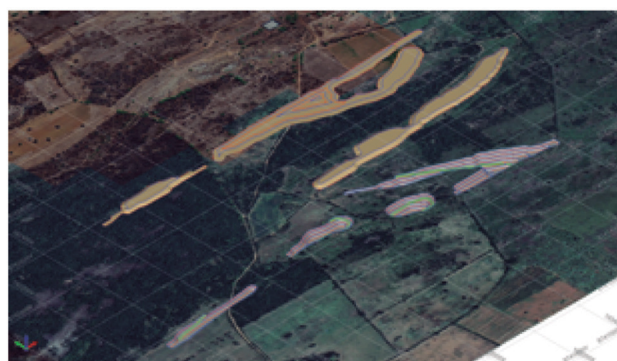
FIGURA 3.7.2 Vista oblíqua (NE) do Modelo Digital de Terreno – MDT do Alvo Três Irmãs, com as configurações finais previstas para as cavas (em cinza) e depósitos de estéril (em bege). Em azul a crista do talude, em vermelho o pé do talude e em verde as rampas de acesso.
