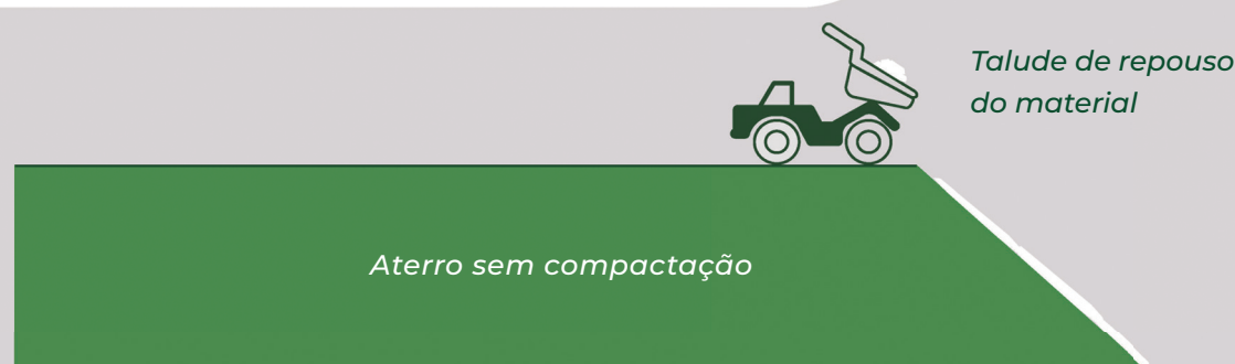
FIGURA 3.4.2.2 Esquema construtivo de pilha de estéril pelo método descendente. Fonte: Aragão, 2008.
